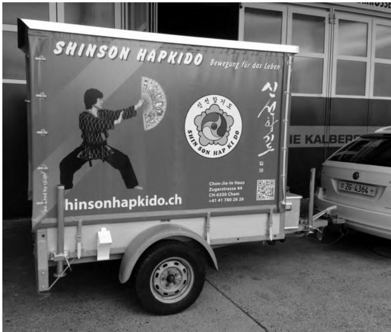
Da der kleine Transport-Anhänger in die Jahre gekommen ist und renoviert werden musste, entschieden wir uns diesen komplett neu aufzubauen. Der bisherige braune Siebdruckplatten-Kofferaufbau wurde komplett ersetzt mit einem selbst gebauten neuen Blachen-Verdeck und einer Auffahrrampe als Heckdeckel.
